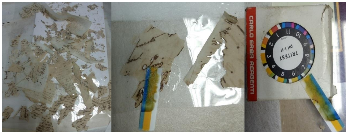
Figura 5. Deterioro por acidez, pero siempre se encontraran varias causas de deterioro interviniendo al unísono; toma de pH
